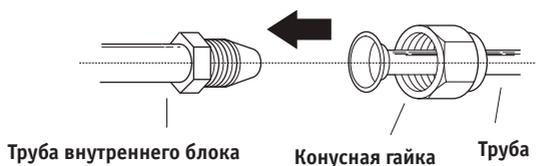
2. Затяните конусную гайку вручную до упора.
