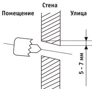
**ПРИМЕЧАНИЕ:** Для кондиционеров с диаметром трубы газовой линии 16 мм и более диаметр стенового отверстия должен составлять 90 мм.
