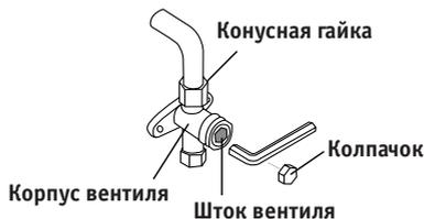
12. С помощью шестигранного ключа полностью откройте клапаны высокого и низкого давления.
