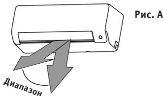
**ПРИМЕЧАНИЕ:** Не перемещайте жалюзи вручную. Это может сделать их автоматическое перемещение несинхронным. Если это произойдет, выключите кондиционер и извлеките вилку кабеля питания из розетки на несколько секунд. При последующем включении питания нормальное функционирование жалюзи будет восстановлено.
