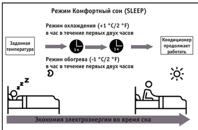
**ПРИМЕЧАНИЕ:** У мульти-сплит систем следующие функции отсутствуют. Функция активной очистки, функция маломощной работы, функция «Бриз», функция обнаружения утечек хладагента и функция экономичной работы (Eco).
