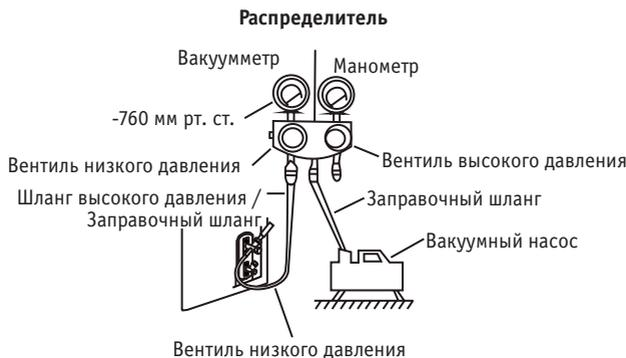
6. Закройте вентиль низкого давления распределителя и выключите вакуумный насос.
