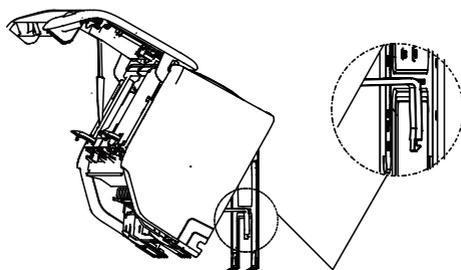
**Шаг 3.** Присоедините дренажный шланг и трубопровод хладагента (см. инструкции в разделе «Подсоединение трубопровода хладагента» данного руководства).
