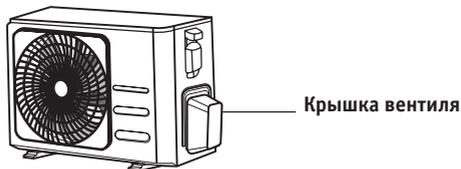
5. Пользуйтесь динамометрическим ключом. Удерживая корпус вентиля, затяните конусную гайку с рекомендованным моментом.
