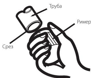
5. Установите комплектные гайки на трубки, с которых уже удалены заусенцы. Гайки должны быть расположены в правильном направлении. **После развальцовки труб установить гайки уже нельзя!**
