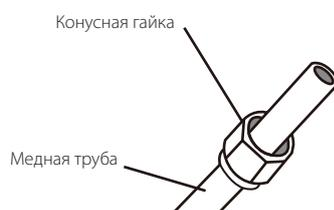
6. Зажмите форму для развальцовки на конце трубы. Конец трубы должен выступать за край формы для развальцовки согласно размерам, указанным в следующей таблице.
