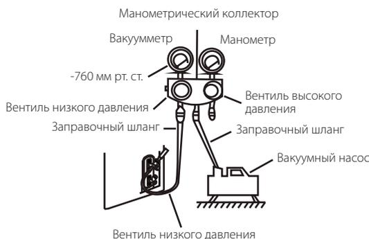
7. Закройте вентиль низкого давления на манометрическом коллекторе. Выключите вакуумный насос. Подождите 5 минут и убедитесь в том, что давление в системе не меняется.
