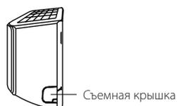
2. С помощью подпорки или клина подоприте блок, чтобы беспрепятственно выполнить присоединение фреонпровода, межблочного кабеля и дренажного шланга.
