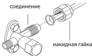
4. Затяните накидную гайку динамометрическим ключом с моментом, указанным в таблице ниже.
