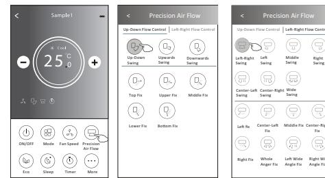
**Примечание:** Для сплит-систем не оснащенных автоматическими вертикальными жалюзи при активации данной функции вы услышите звуковой сигнал, однако сама функция активизирована не будет.
