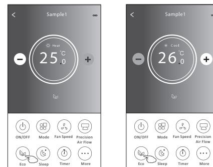
1. Для активации функции SMART ECO просто нажмите на кнопку, кнопка загорится, на экране появится вентилятор.
