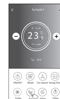
**Примечание:** Функция SMART ECO активна только в режимах охлаждение и нагрев.
