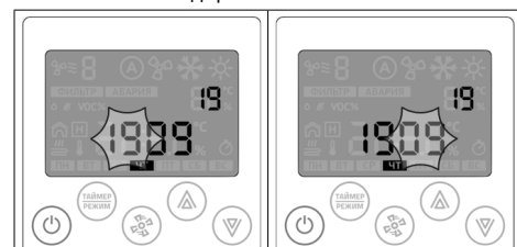
Стрелками «вверх» или «вниз» устанавливается число. Переход к редактированию месяца — нажать кнопку «вентилятор». Стрелками «вверх» или «вниз» устанавливается месяц. Переход к редактированию года — нажать кнопку «вентилятор».
