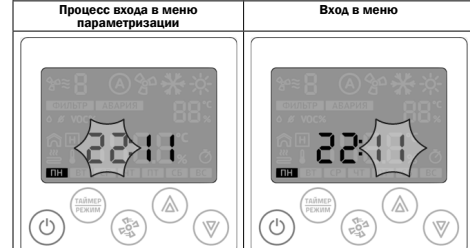
Стрелками «вверх» или «вниз» устанавливаются часы. Переход к редактированию минут — нажать кнопку «вентилятор». Стрелками «вверх» или «вниз» устанавливаются минуты. Переход к редактированию даты — нажать кнопку «вентилятор».
