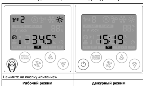
Стрелками «вверх» или «вниз» устанавливаются часы. Переход к редактированию минут — нажать кнопку «вентилятор». Стрелками «вверх» или «вниз» устанавливаются минуты. Переход к редактированию даты — нажать кнопку «вентилятор».
