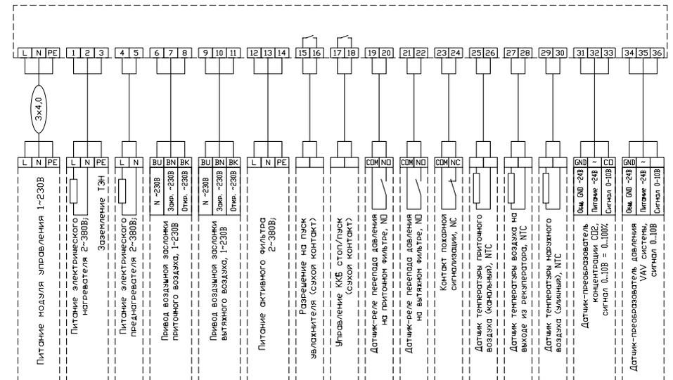
Схема подключения ZPVP 450 PE EC, ZPVP 850 PE EC
