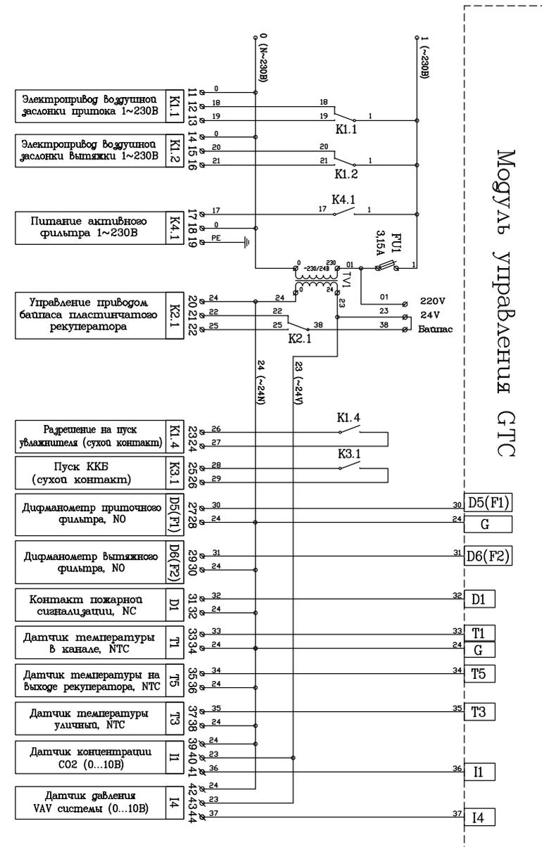
Схемы подключения ZPVP 450 PW EC, ZPVP 850 PW EC
