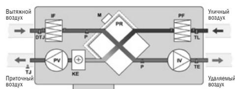
DTJ – датчик температуры и влажности вытяжно-го воздуха;
