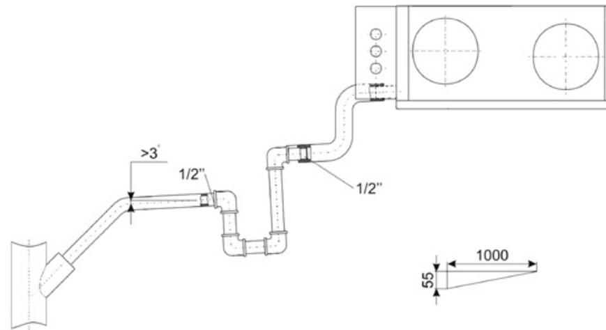
Уклон труб должен быть не менее 3° (1 м трубы должен быть наклонен вниз на 55 мм).
