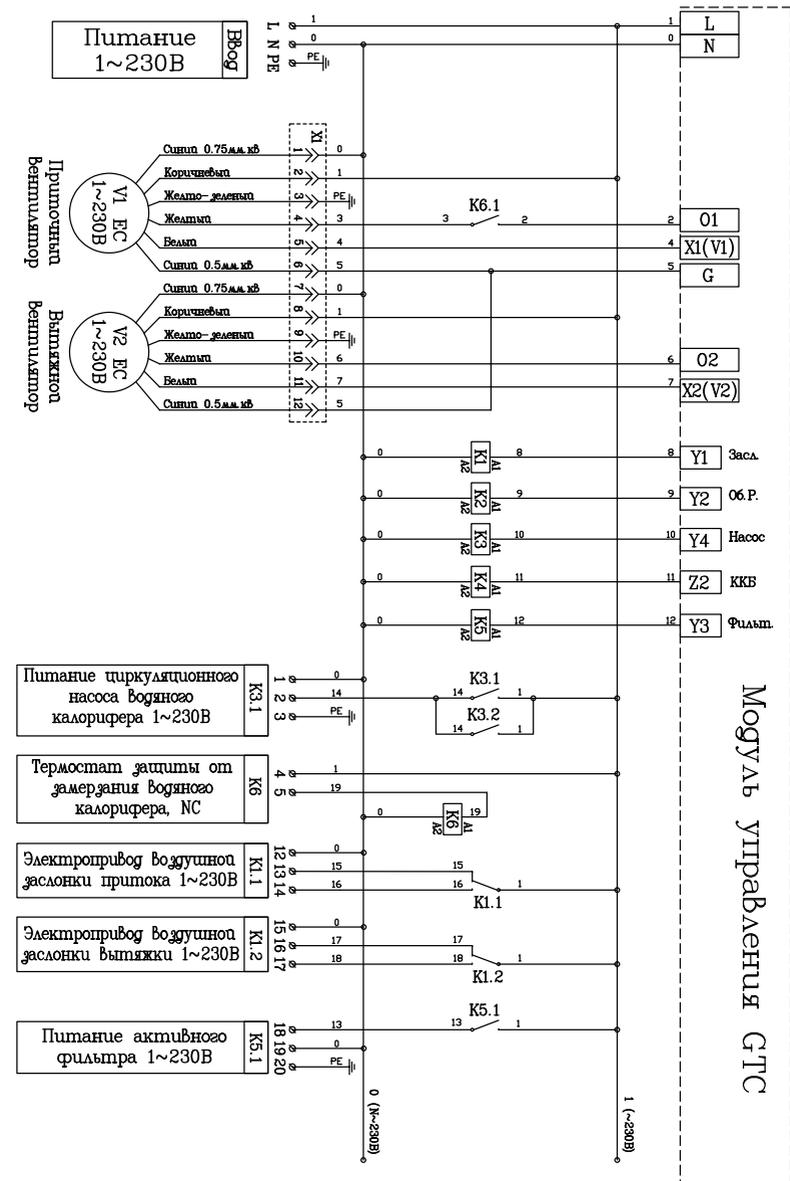
Схемы подключения ZPVP 1400 PW EC, ZPVP 2200 PW EC
