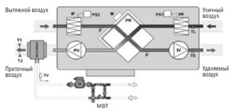
TE – датчик температуры удаляемого воздуха;
