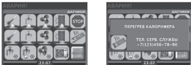
Запуск системы при наличии сигналов аварии невозможен, и каждый раз при нажатии кнопки ПУСК будет выводиться окно АВАРИЯ, до тех пор, пока активные аварии не будут сняты и сброшены.
