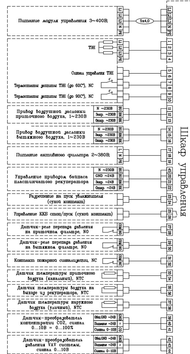
Схемы подключения ZPVP 1400 PE EC, ZPVP 2200 PE EC
