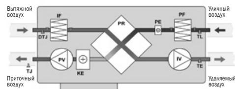
PV – вентилятор приточного воздуха;
